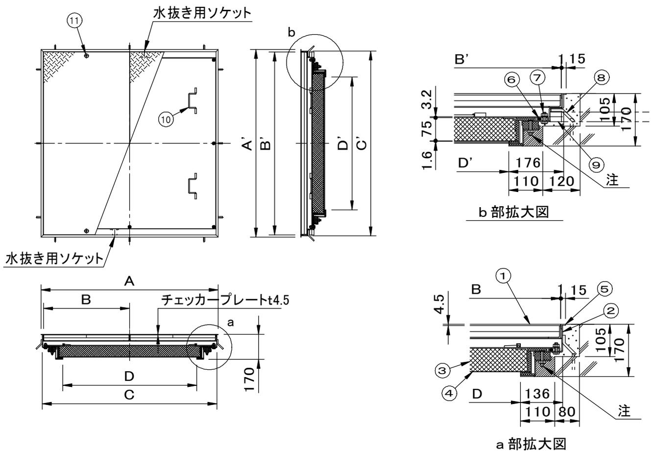
注:ボルトが露出しない様にモルタル不燃材等で埋めて下さい。
